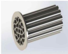
튜브 번들 유량 교정기는 파이프에 단단히 고정되어 있는 평행 및 접선 튜브 번들로 구성됩니다. 다양한 튜브가 서로 평행하고 파이프 축과 평행해야 합니다. 이 요구 사항이 충족되지 않으면 교정기 자체가 흐름에 소용돌이를 일으킬 수 있기 때문입니다. 튜브는 최소 19개 이상이어야 합니다. 길이는 10dt 이상이어야 하며, 여기서 튜브 dt의 직경은 그림에 나와 있습니다.
